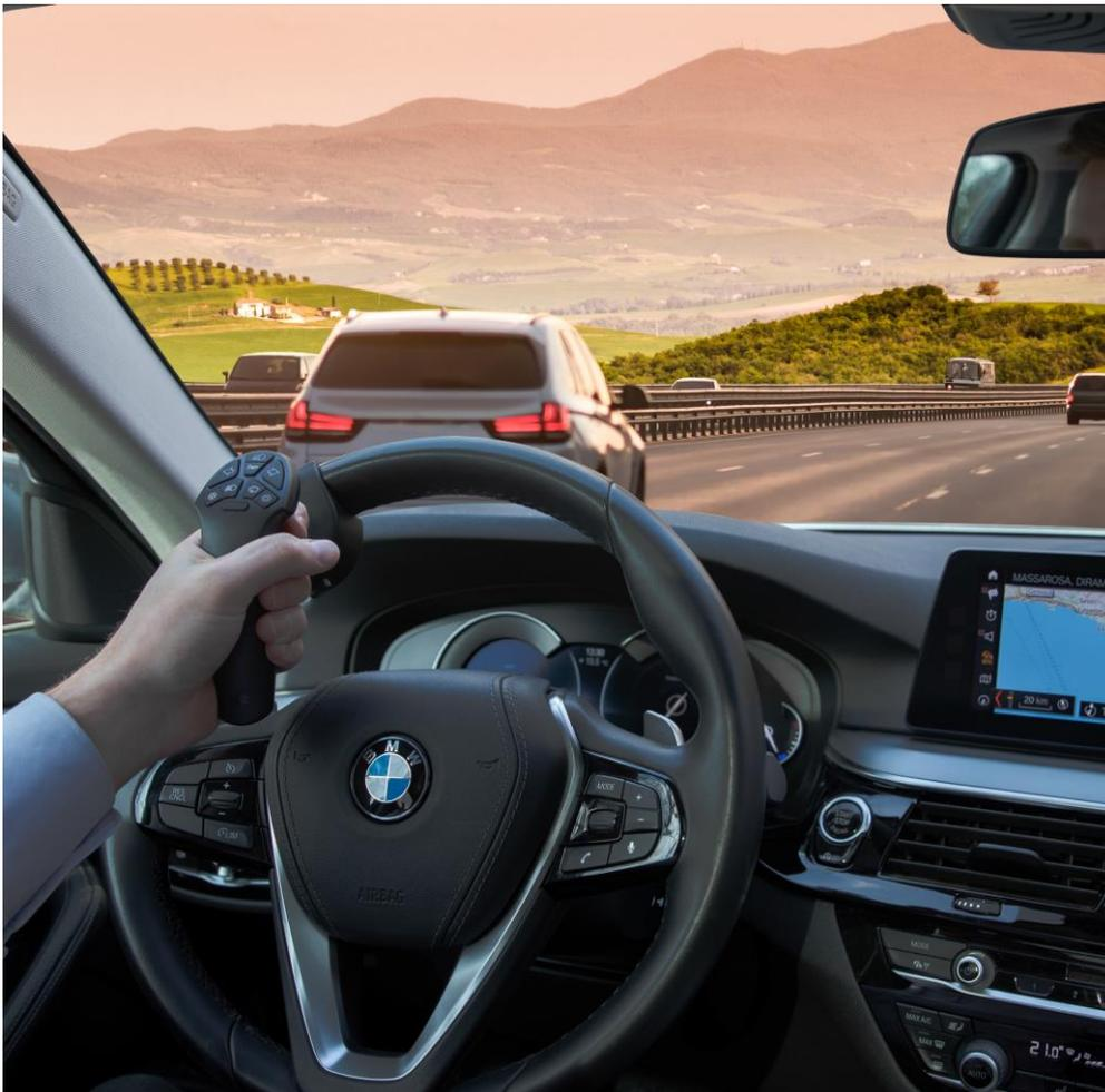
Mit dem Multifunktionsdrehknopf können Sie einfach und sicher Funktionen wie Scheibenwischer, Blinker, Beleuchtung, bedienen und gleichzeitig die Kontrolle über das Lenkrad behalten. Der Multifunktionsdrehknopf wurde so entwickelt, dass die Funktionen in jeder Lenkradstellung gut erreichbar bleiben.
